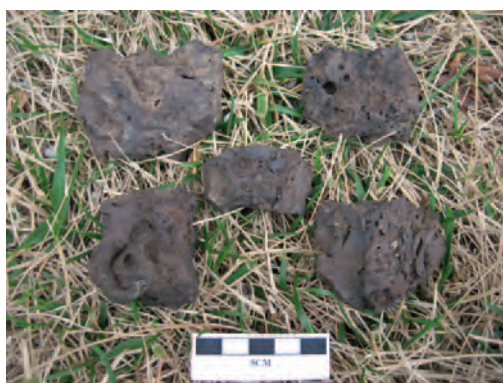
图三 广西兴业唐宋时期生铁排出片状炉渣形貌
